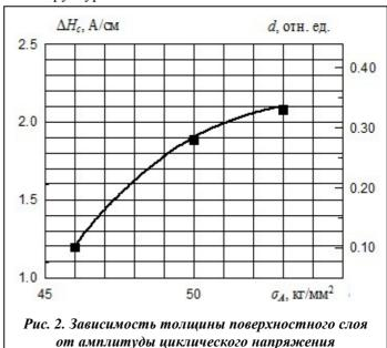
Результаты испытаний образцов в исходном состоянии (нормализация) свидетельствуют о том, что у всех образцов после испытаний повышается значение коэрцитивной силы [7]. Увеличение коэрцитивной силы в исследованном диапазоне амплитуд нагружения (42–60 кг/мм $^2$ ) составило от 60 до 110%.
