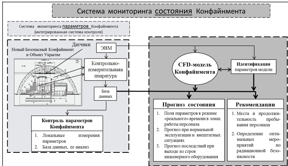
Рис. 2. Система мониторинга состояния Нового Безопасного Конфайнмента и Объекта Укрытие.
