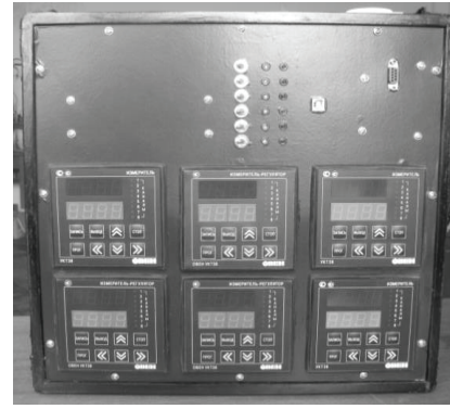
Рис. 1. Зовнішній вигляд блоку теплової реєстрації.
