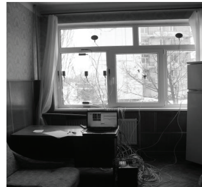
Рис. 2. Схема розміщення датчиків на віконних конструкціях, вид зсередини приміщення (а) та фотографія (б) досліджуваної віконної конструкції з розміщеними датчиками та підключеним вимірювальним комплексом (вигляд зсередини приміщення).
