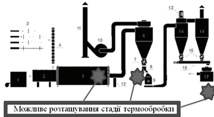
Рис. 5. Можливі місця розташування стадії термообробки на класичній лінії виробництва біопалива: 1 – газовий паливник; 2 – змішувач; 3 – склад сировини; 4 – транспортер; 5 – барабанна сушарка; 6 – великий циклон; 7 – шлюзовий затвор; 8 – розподілювач; 9 – молоткова дробарка; 10 – димосос; 11 – труба димососа; 12 – відбиральник; 13 – вентилятор; 14 – циклони; 15 – дозатори (шлюзові затвори); 16 – шнекова подача; 17 – гранулятор.
