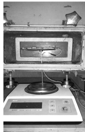
Рис. 1. Схема експериментального стенду конвективного сушіння та сушильної камери: 1 – сушильна камера; 2 – калорифер; 3 – вентилятор; 4 – блок регулятор температури; 5 – пульт керування; 6 – термометри опору; 7 – патрубки з шиберами; 8 – психрометр; 9 – решітки стабілізації потоку; 10 – штанга вагів; 11 – ваги.
