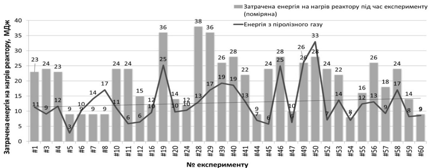
Рис. 6. Можливість покриття потреб енергії на нагрів реактора за рахунок утилізації піролізного газу.
