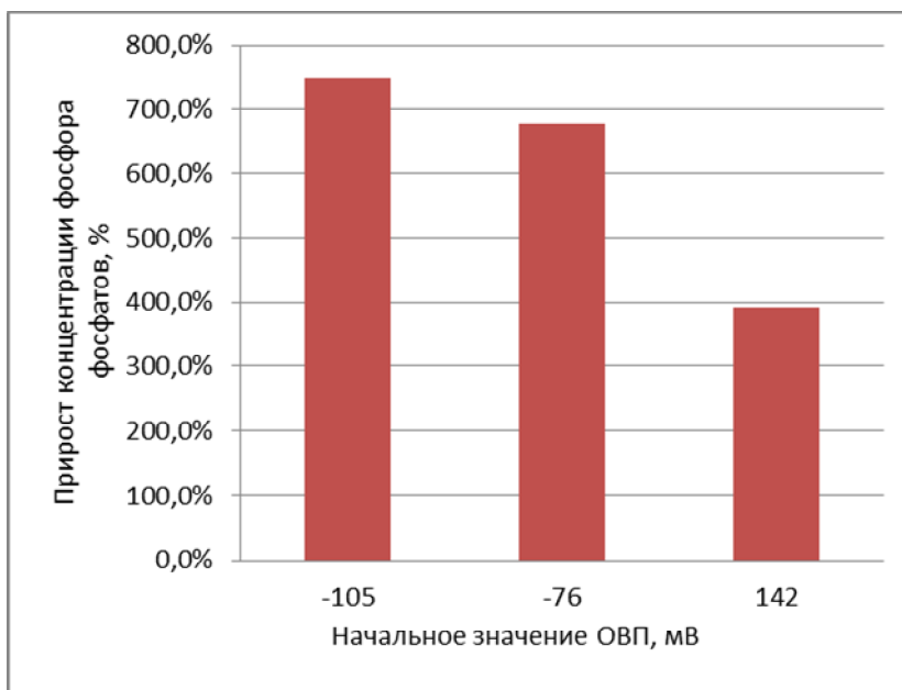
Рис. 2. Повышение концентрации фосфора ортофосфатов в сырой сточной воде в зависимости от начального уровня ОВП
