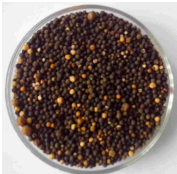
Рис. 1. Полімерні гранули фільтруючого завантаження, покриті характерною темно-коричнево-чорною плівкою, вірогідно з вищих оксидів марганцю, і жовто-рудюю плівкою з Fe_2O_3 , що утворилася при зневодненні Fe(OH)_3 .
