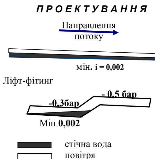
Рис. 4. Пристрій ліфт-фітингу на трубопроводі
