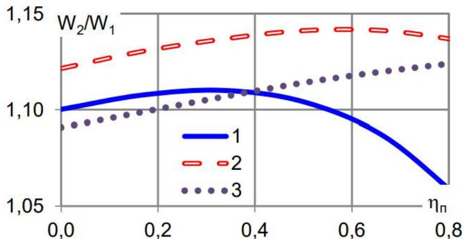
Рис. 2. Влияние высоты расположения переливной перегородки и размера зерен загрузки на эффективность работы фильтра:
