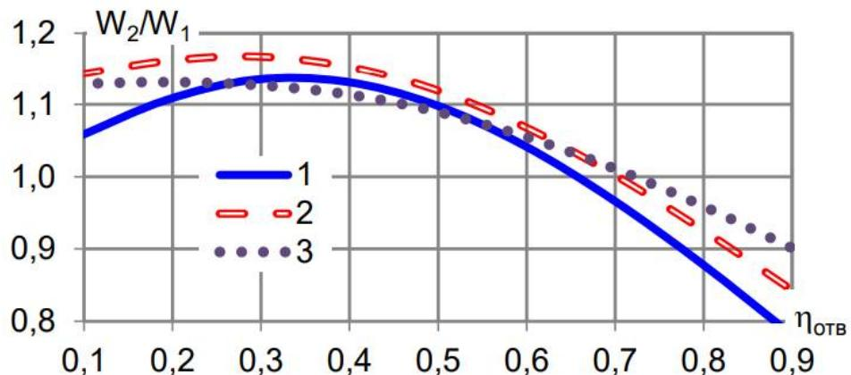
Рис. 2. Влияние параметров  $\eta_{\text{отв}}$  и  $d_{23.3}/d_{13.3}$  на эффективность работы фильтра: 1 –  $d_{23.3}/d_{13.3} = 1,2$ ; 2 –  $d_{23.3}/d_{13.3} = 1,4$ ; 3 –  $d_{23.3}/d_{13.3} = 1,7$
