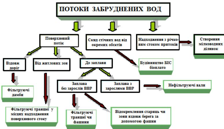
Рис.1. Схема вибору водоохоронних заходів на основі алгоритму використання фіtotехнологій з врахуванням елементів водної екосистеми
