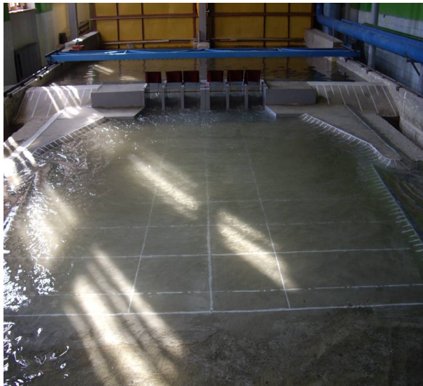
Фото. 3. Гідравлічні дослідження водозабірної (впускної) споруди польдера «Вари-Четфалва» і на р. Тиса в Закарпатській обл. (моделювання наповнення польдера в гідротехнічній лабораторії НУВГП)
