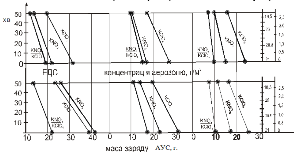
Рис. 1. Залежність часу горіння метану від концентрації аерозолу та наважки заряду АУС.
