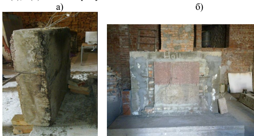
Рис. 7. Вигляд дослідного зразка марки СФБ-1,2 після випробування
