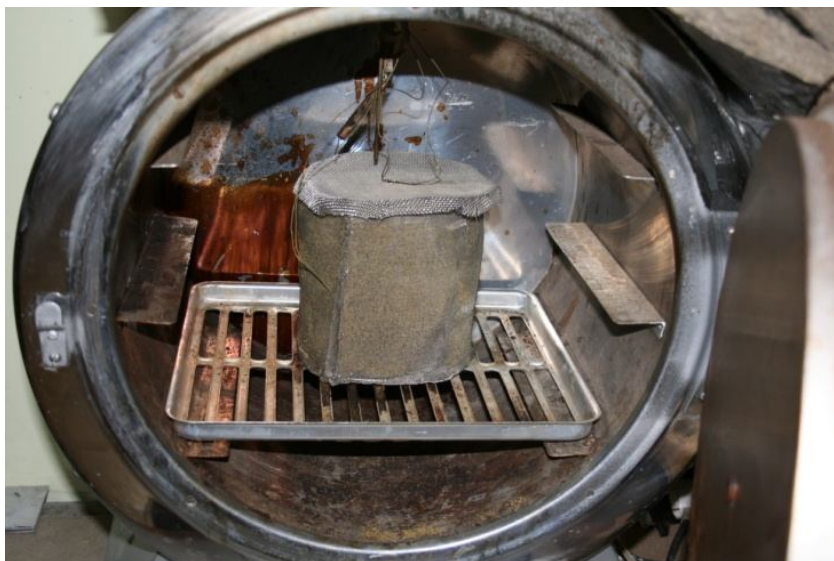
Рисунок 2 – Дослідний зразок встановлений у термошафу для дослідження умов теплового самозаймання ріпакової маси
