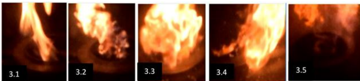
Рисунок 3 – Розкадровка при гасінні CO_2 та впливі на ДПГ ударних хвиль з частотою 10Гц
