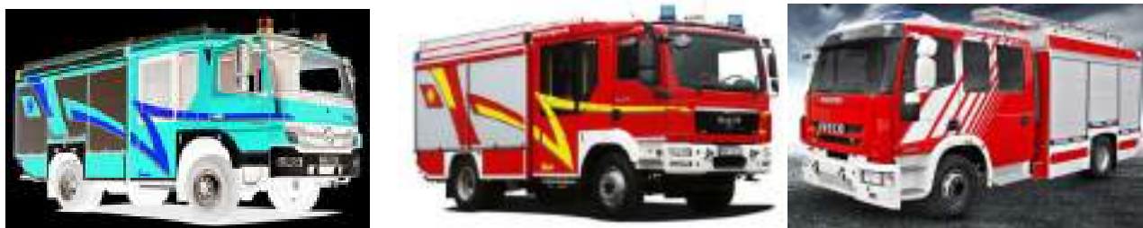
Рисунок 9 — Пожежно-рятувальні автомобілі на шасі Mercedes Benz Atego II, MAN TGM та Iveco Eurocargo
