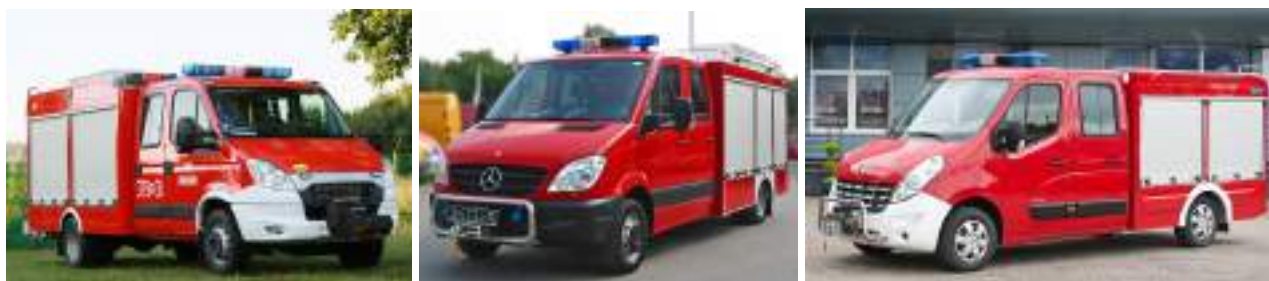
Рисунок 8 — Пожежно-рятувальні автомобілі на шасі Iveco Daily, Mercedes Benz Sprinter та Renault Master
