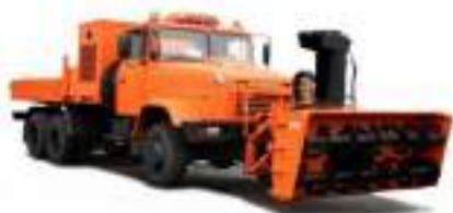
Рисунок 31 — Автомобілі з снігоочисниками: а) активним; б) пасивним
