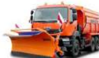
Рисунок 31 — Автомобілі з снігоочисниками: а) активним; б) пасивним
