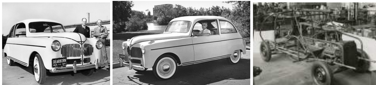
Рисунок 2 — Дослідний автомобіль Ford з пластмасовим кузовом
