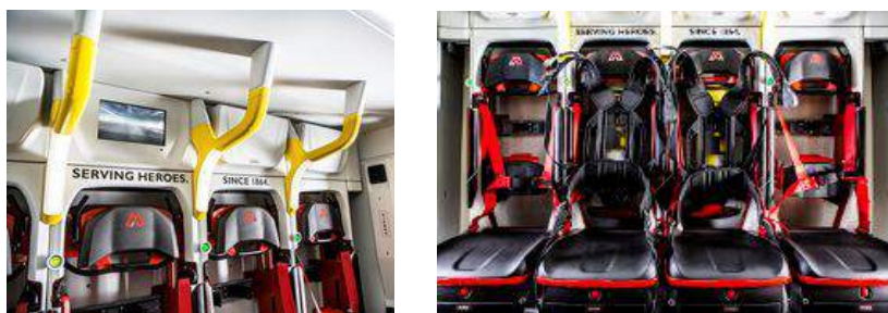
Рисунок 16 — Кабіна бойового розрахунку з системами пасивної безпеки
