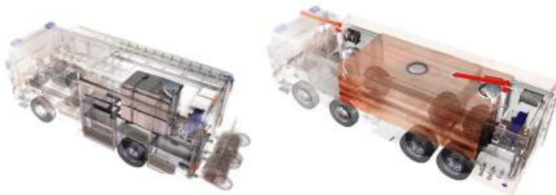
Рисунок 18 — Компоновання помпи, резервуара для води та надбудови автомобіля для пожежогасіння
