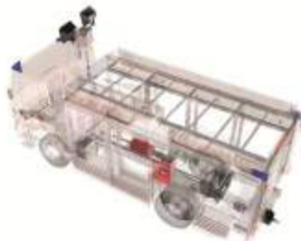
Рисунок 19 — Компонування надбудови рятувального автомобіля
