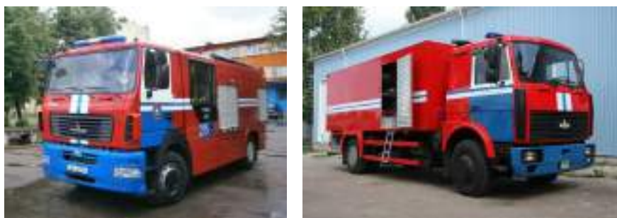
Рисунок 27 — Автомобіль комбінованого гасіння та насосно-рукавна станція, виготовлені компанією Tital (Україна) для МНС Республіки Білорусь
