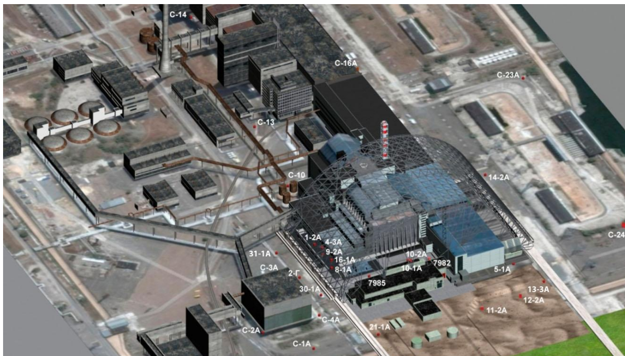
Рис. 1. Схема розташування спостережних свердловин радіогідроекологічного моніторингу на ділянці розташування комплексу НБК-ОУ.
