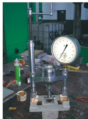
Рис. 2. Експериментальний стенд для визначення адгезійної міцності системи «покриття–бетон»
