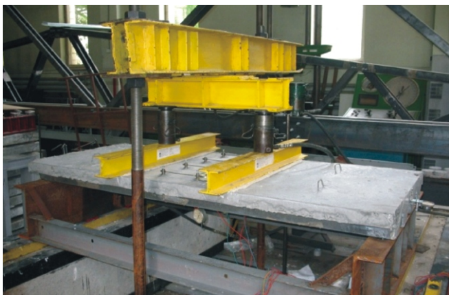
Рис. 2. Експериментальна установка для випробування плит
