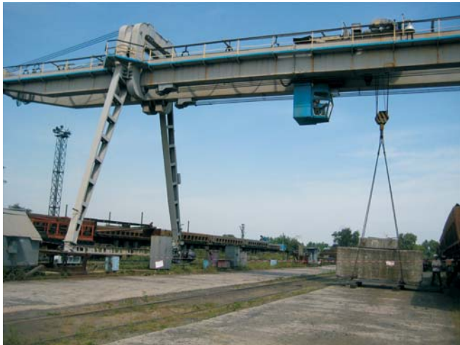
Рис. 1. Общий вид модернизированного козлового крана грузоподъемностью 20 т пролетом 32 м
