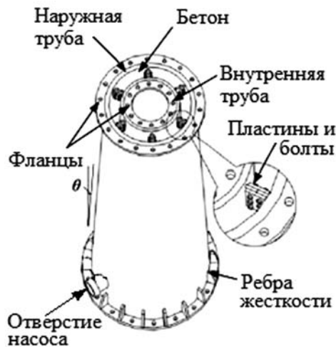
Рис. 3. Ствол трубобетонной опоры с двойной оболочкой (CFDST)
