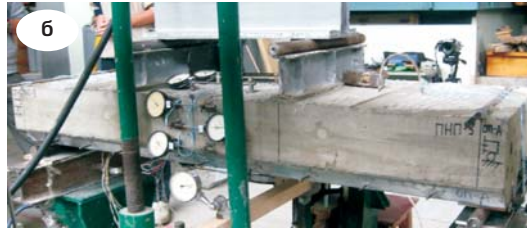
Рис. 2. Статична схема випробування зразків (а) та загальний вигляд зразка ПНП-3 у випробувальному стенді (б)
