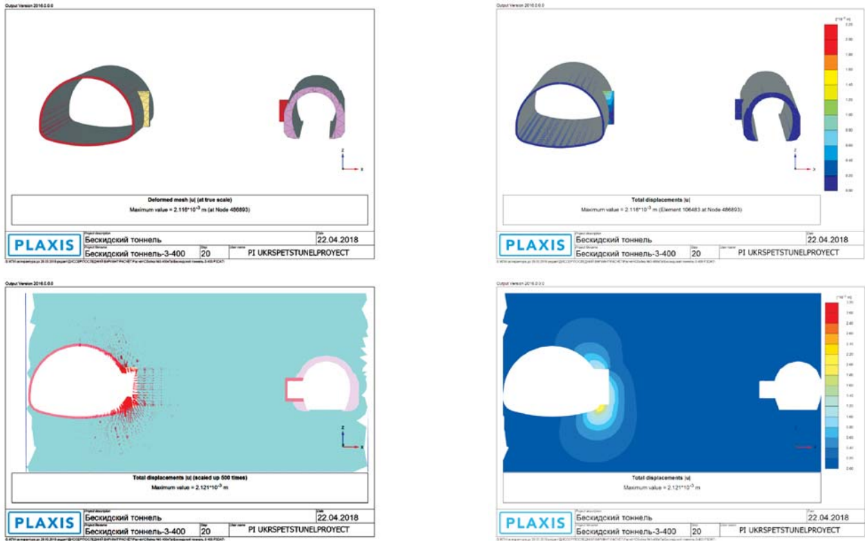
Рис. 6. Общие деформации в геосистеме при длине тупиковой выработки (сбойки), равной 1 м
