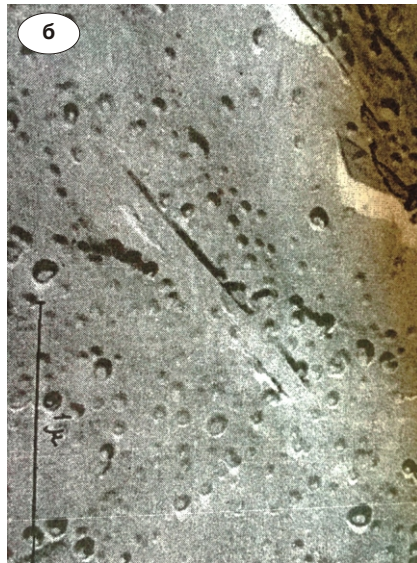
Рис. 1. Мікрофотографія репліки з поверхні C_3S після перебування у воді протягом однієї години (а) та протягом чотирьох годин (б)
