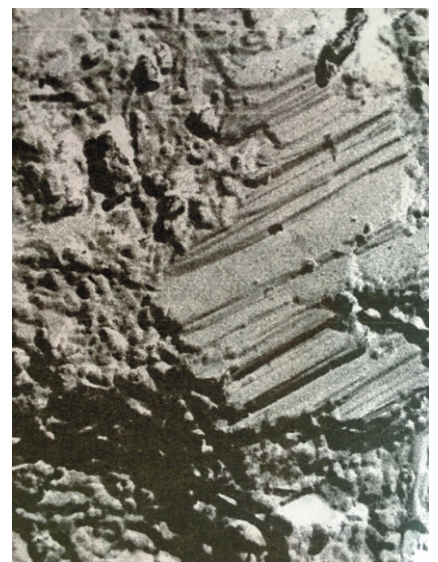
Рис. 5. Мікрофотографія репліки зі сколу каменю C_3S , який тверднув один рік
