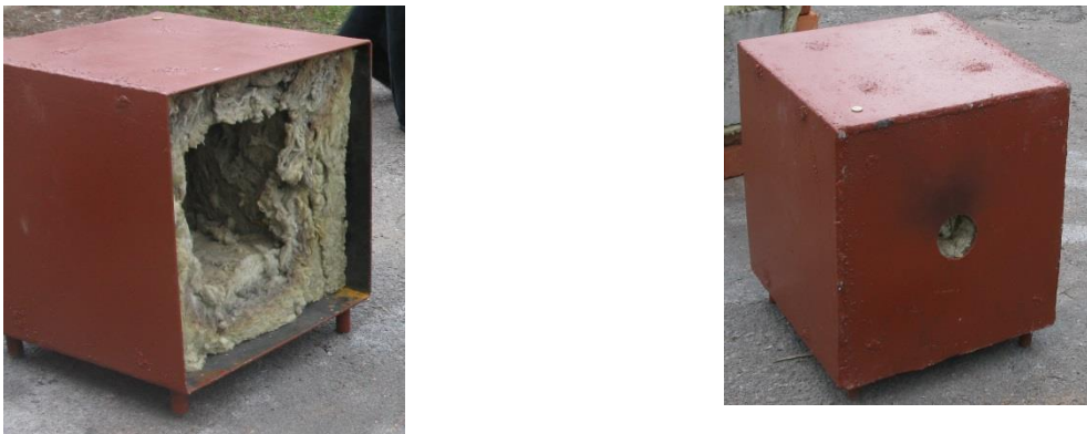
Рисунок 2 – Установка для визначення ТФХ бетону.
