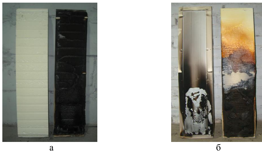
Рисунок 3 – Внешний вид образцов до и после испытаний по методу П ДСТУ Б В.2.7-19-95: а - утеплитель PIR; б- сэндвич-панели и внутренний слой из утеплителя PIR.
