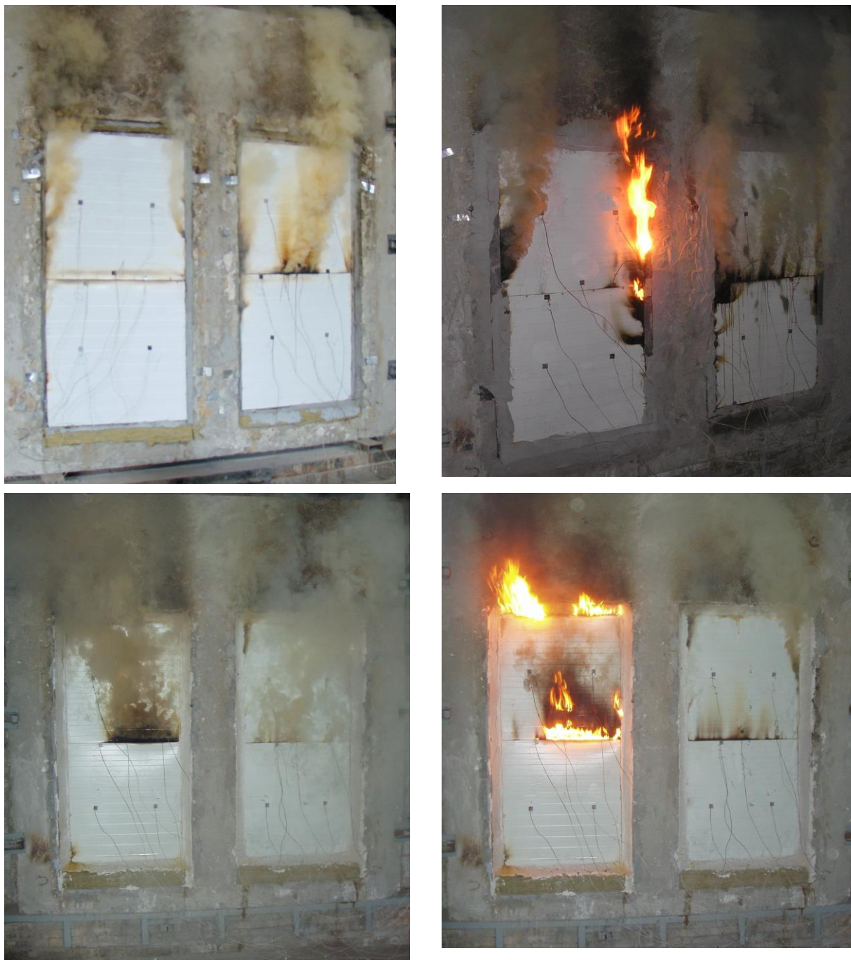
Рисунок 8 – Выделение газообразных продуктов горения из образцов сэндвич-панелей с утеплителем PIR во время проведения испытаний по ДСТУ Б В.1.1-4-98*.
