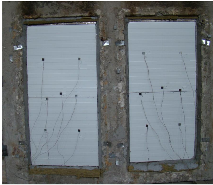
Рисунок 4 – Вид образцов сэндвич-панелей в опорной конструкции печи до и после испытаний по ДСТУ Б В.1.1-4-98* .
