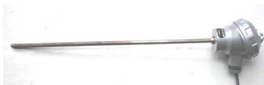
Рисунок 3 – Термопара ТХА 1-27-К-2-И-320-INC-6-A-(0...1100)°С.
