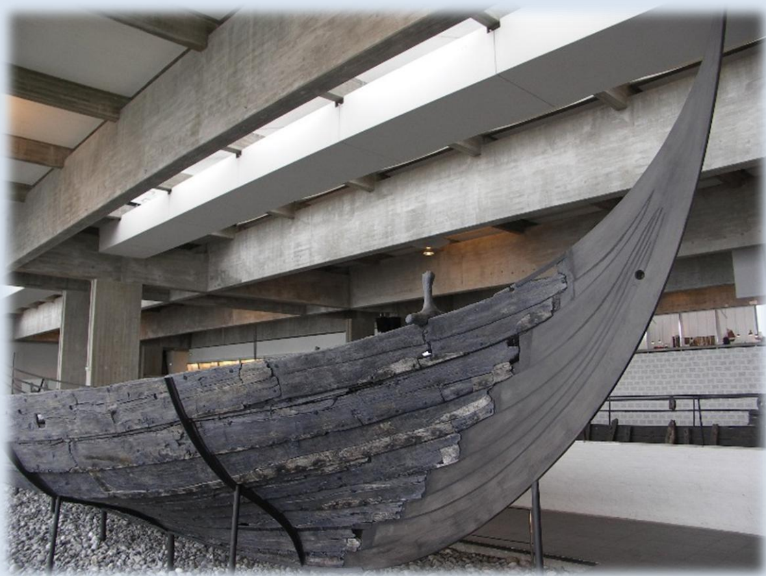
Фото 14. Скульделев 3. Конструкция носа.
