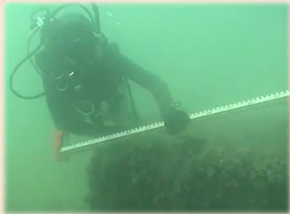
Рис. 31. Металлический бак по правому борту затонувшего судна.
