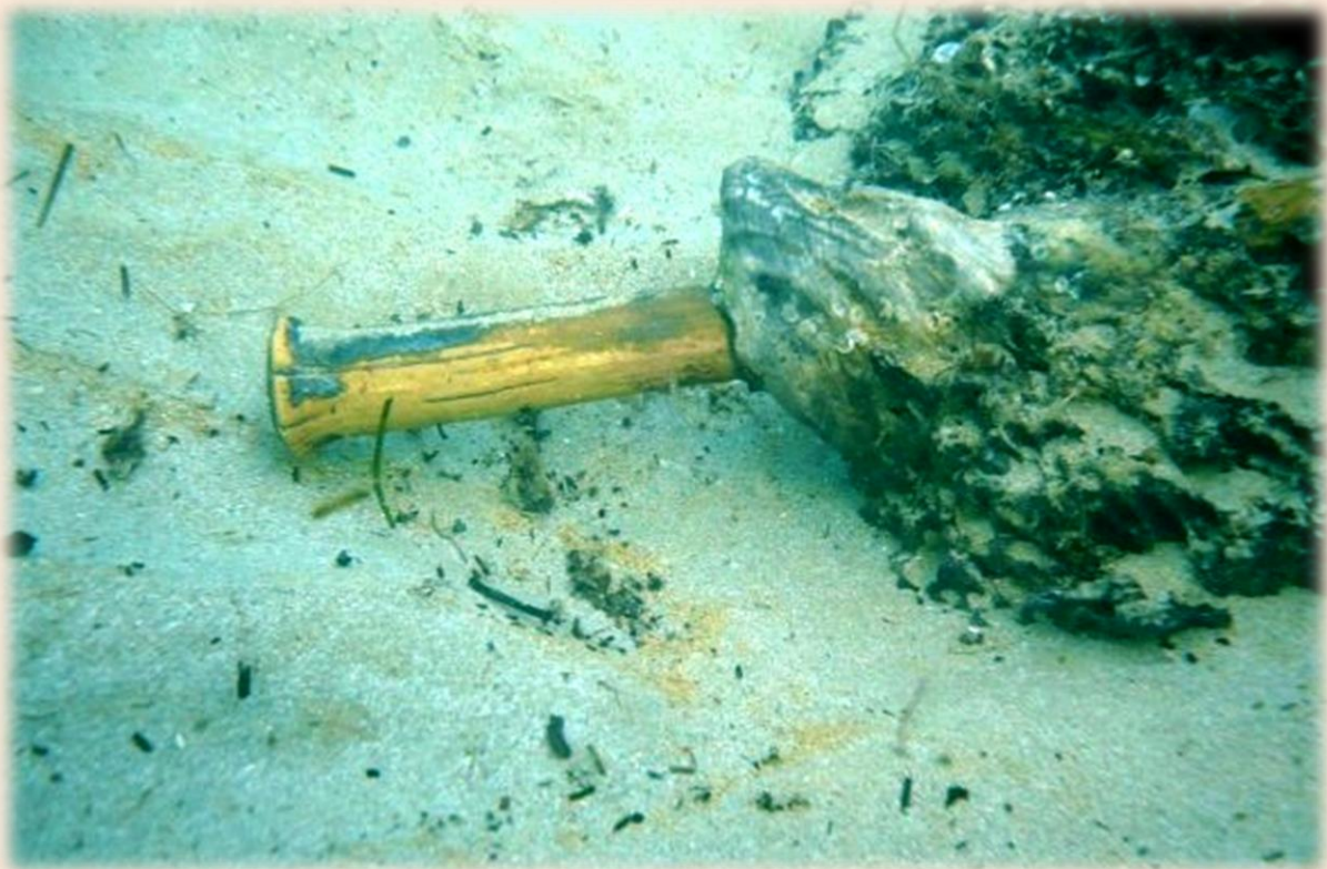
Рис. 39. Медний нагель для кріплення судового набору.
