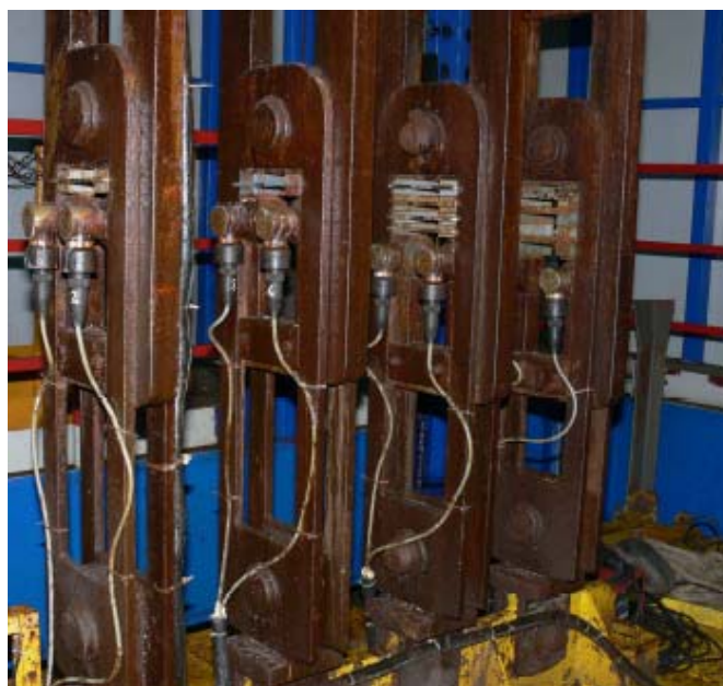
Рис. 1. Устройство для измерений усилий в головных канатах рудничных многоканатных подъемных установок фирмы TEMIX
