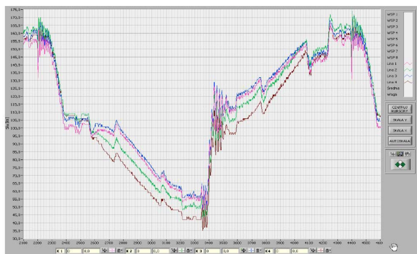
Рис. 4. Графики усилий при выполнении рабочего цикла подъема после регулировки длин канатов
