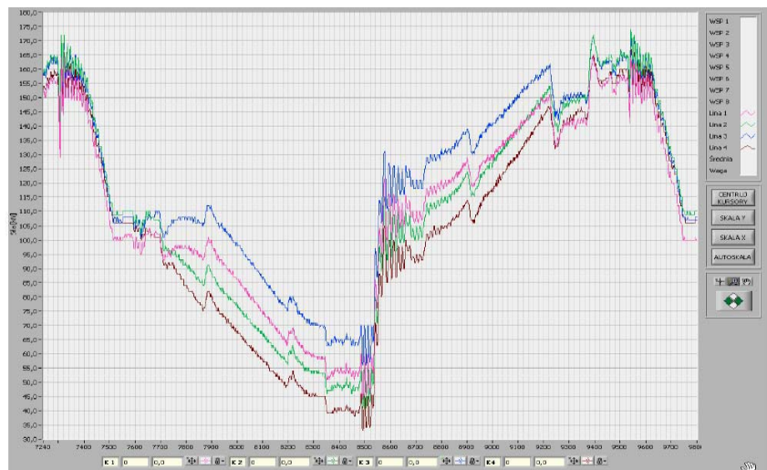
Рис. 3. Графики усилий при выполнении рабочего цикла подъема после регулировки радиусов навивки канатов
