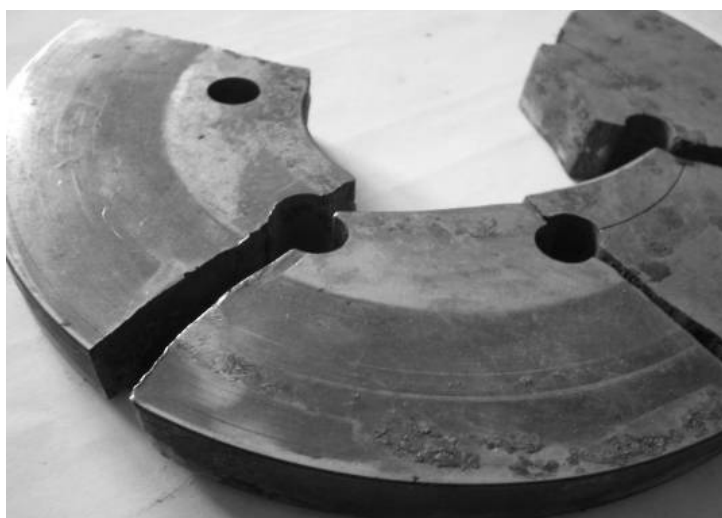
Рис.7. Разрушение пяты опорного узла насоса агрегата АНПШ 375-400 после работы в течение 276 ч. на ГрВК ш. № 27 «Миусская»:
