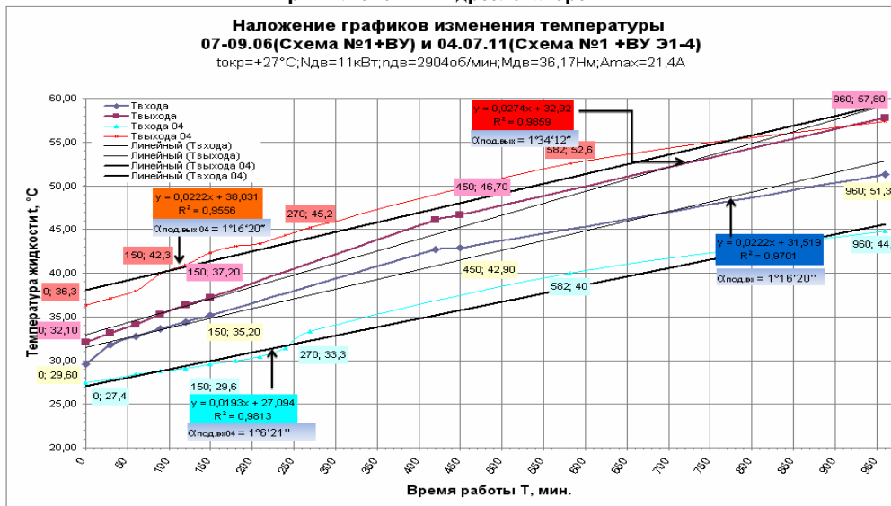
Рис.7. Тренд температуры агрегата термодинамического трехступенчатого во временном интервале от момента пуска до 960 мин. при различных компоновках проточной части. Сопоставление схемы №1 с вакуумирующим узлом с трендом температур схемы № 1 с ВУ при включении элеваторов 1-4
