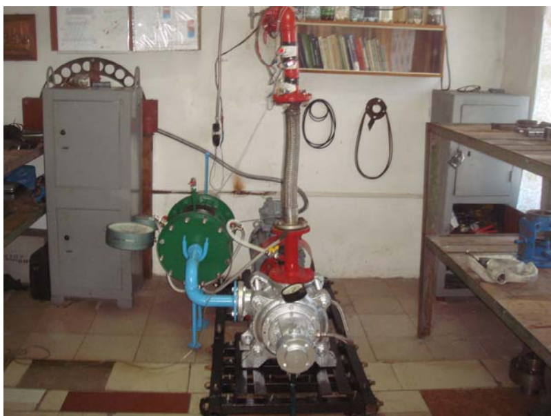
Рис.1. Стенд СдАТМ для комплексных испытаний термодинамических многосекционных установок. Вид на агрегат аномальной генерации тепла и вакуумный узел вращающегося фронта кумулятивных струй
