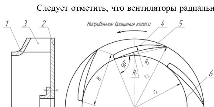
Рис. 1. Рабочее колесо радиального вентилятора с выпукло-вогнутыми лопатками
