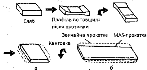
Рисунок 3 — Принцип MAS-прокатки для зменшення бокової обрізи: а – форма розкату в плані після розбивки ширини; б – після прокатки до кінцевої товщини.
