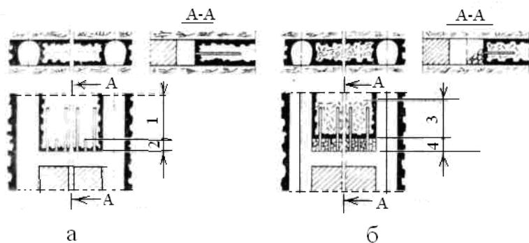
Рис. 4. Схема сотрясательно – камуфлетно – отбойного взрыва: а – положение перед взрывом; б – положение после взрыва; 1 – зона предусмотренного ослабления напряжений; 2 – забой до выемки; 3 – зона ослабленных напряжений; 4 – отбитый уголь.
