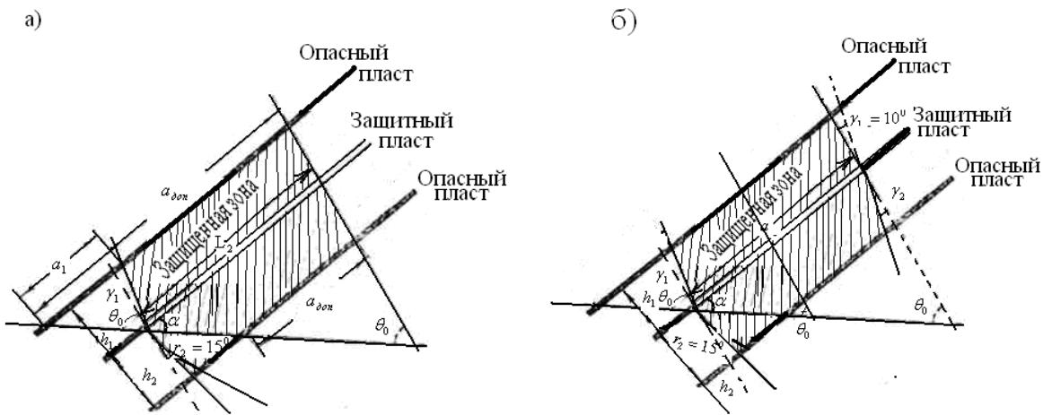
Рис. 7. Схемы к определению границ защищенных зон на разрезе вкрест простириания: а – при ведении работ без целиков у вентиляционного горизонта при  $h$  не более 100 м,  $h$  не более 60 м,  $L = 0,6H$ ; б – при ведении работ с целиками при  $h = 0,7a$ , но не более 100 м,  $h = 0,5a$ , но не более 60 м
