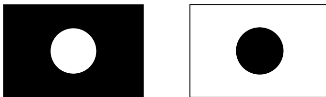
Рис. 5. Схематичне зображення локального катоду (темна – область катоду покрита хімічно стійким лаком, світла – область катоду доступна для осадження): а) S = 0,785 \cdot 10^{-4} м 2 ; б) S = 2,455 \cdot 10^{-4} м 2 , де S - доступна для осадження площа катода.
