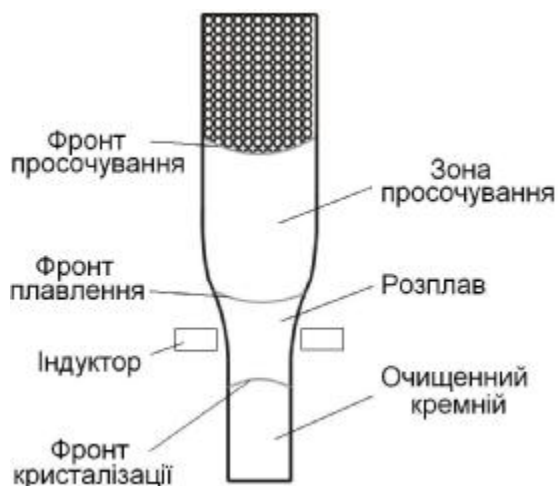
Рис. 1. Схема просочування розплавом пористої заготовки кремнію.
