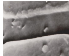
Рис. 3. Схема технологічного процесу взривної літографії (а), рельєф в 0,5мкм отриманий взривною літографією в алюмінієвому сплаві АКГо-1-1 (б).
