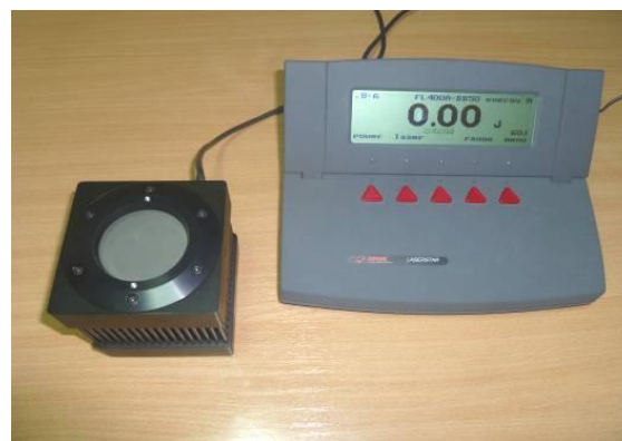
Рис. 2. Вимірювач потужності лазерного випромінювання «Lazer Star Orphi».
