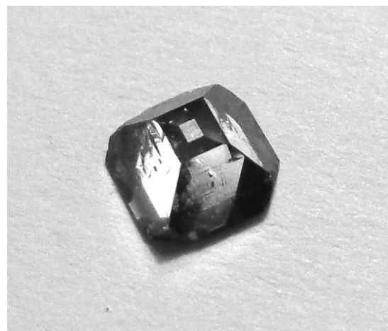
Рис. 1. Внешний вид облученного электронами монокристалла алмаза, использованного для исследования.
