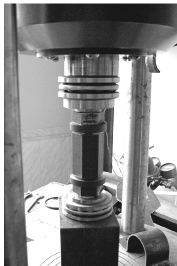
Рис. 1. Устройство для 3D-PT деформации: матрица и скошенные поршни
