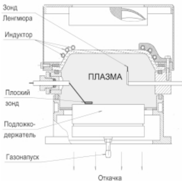
Рис. 1. Принципиальная схема и фотография плазмохимического реактора.
