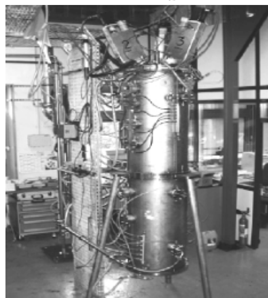
Рис. 9. Схема установки с 3-х фазным дуговым плазмотроном (а) и ее фотография (б).
