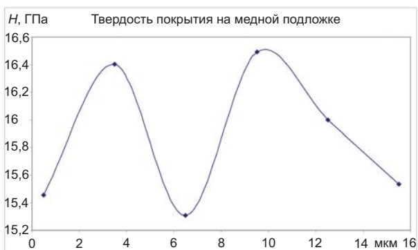
Рис. 7. Нанотвердость покрытия на медной подложке
