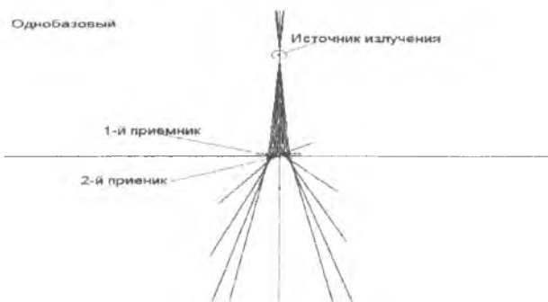
Рисунок 2 - Определение координат источника несанкционированного излучения в однобазовом разностно-дальномерном комплексе с переменной базой
