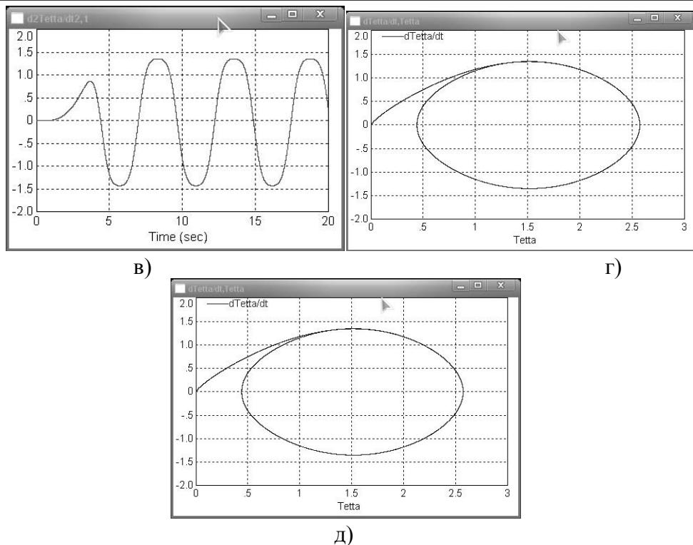
Рис.1. Графіки функцій переміщення (а), кутової швидкості (б), кутового прискорення (в), класичний фазовий портрет (г) та фазовий портрет вищого порядку(д) вантажу при  $\alpha = 5$ ,  $\beta = 2,6 \text{ c}^{-2}$ ,  $\omega_0 = 0,8 \text{ рад/с}$ ,  $t_n = 5\text{с}$ ,  $l = 3,77\text{м}$ ,  $r_0 = 18,85 \text{ м}$ .
