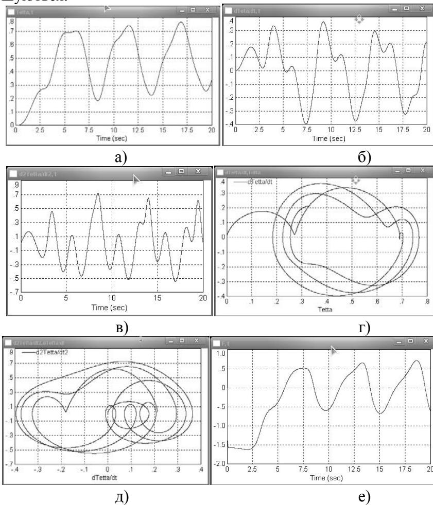
Рис.3. Графіки функцій переміщення (а), кутової швидкості (б). кутового прискорення (в), класичний фазовий портрет (г) та фазовий портрет вищого порядку(д) вантажу при  $\alpha= 5$ ,  $\beta=2,6$  с-2,  $\omega_0=0.8$  рад/с,  $t_n=5$  с,  $l=3.77$  м,  $r_0=7,54$  м, F – кут відхилення маятника від вертикалі в площині повороту (е),
