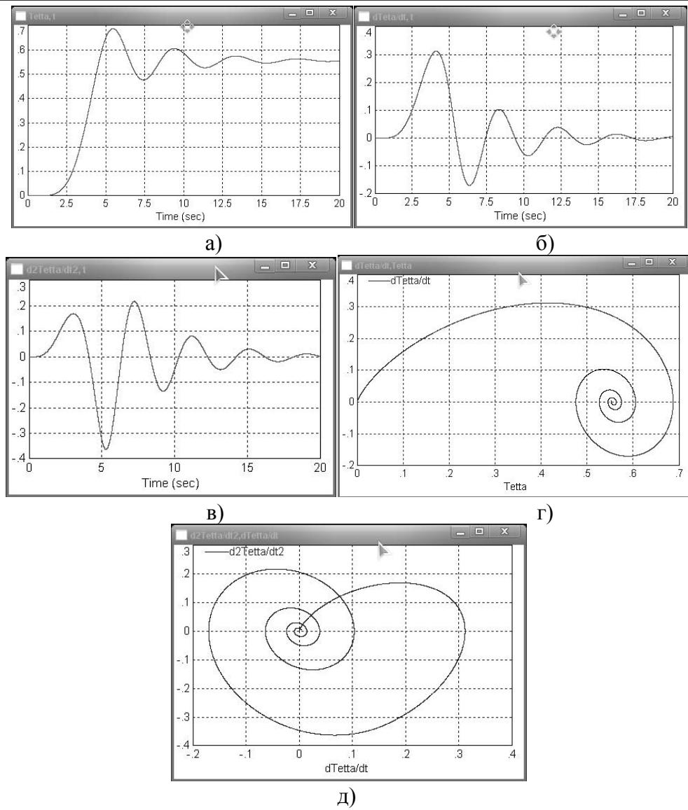
Рис.2. Графіки функцій переміщення (а), кутової швидкості (б). кутового прискорення (в), класичний фазовий портрет (г) та фазовий портрет вищого порядку (д) вантажу при  $\alpha=5$ ,  $\beta=2,6$  с<sup>-2</sup>,  $\omega_0=0.8$  рад/с,  $t_n=5$  с,  $l=3.77$  м,  $r_0=7,54$  м з урахуванням затухання  $\gamma=0,5$  с<sup>-1</sup>
