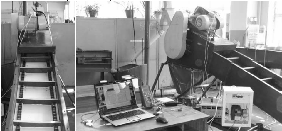
Рис. 7. Загальний вигляд експериментальної установки з вимірювально-реєструючим обладнанням
