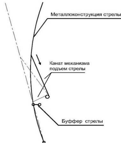
Рисунок 3 – Расчетная схема для расчетного случая нерабочего положения морской консоли
