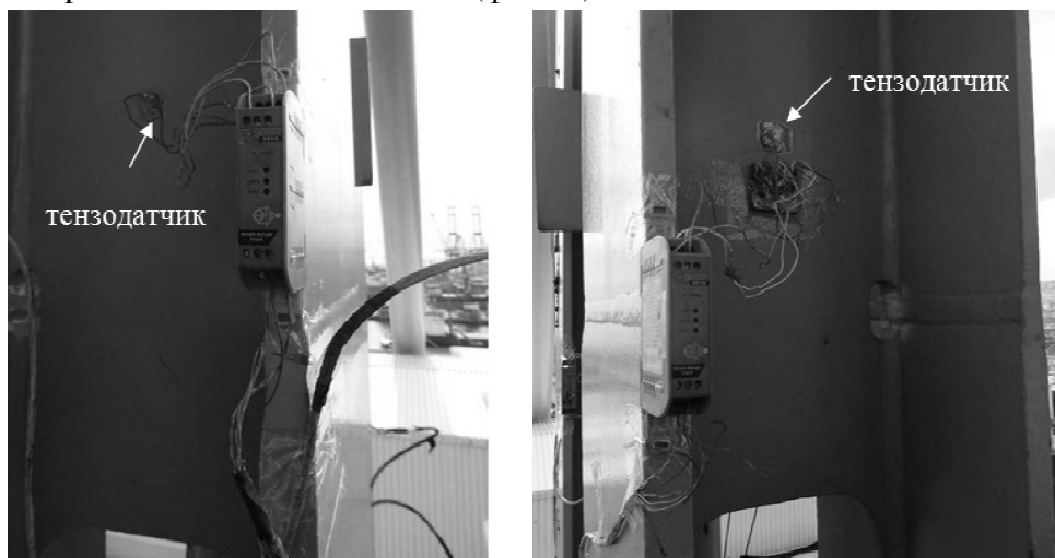
Фото 3 – Крепление тензодатчиков к металлоконструкциям тяг морской консоли
