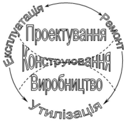
Рисунок 4 – Узагальнена структурна схема життєвого циклу технічних систем виробів та їх взаємного впливу.
